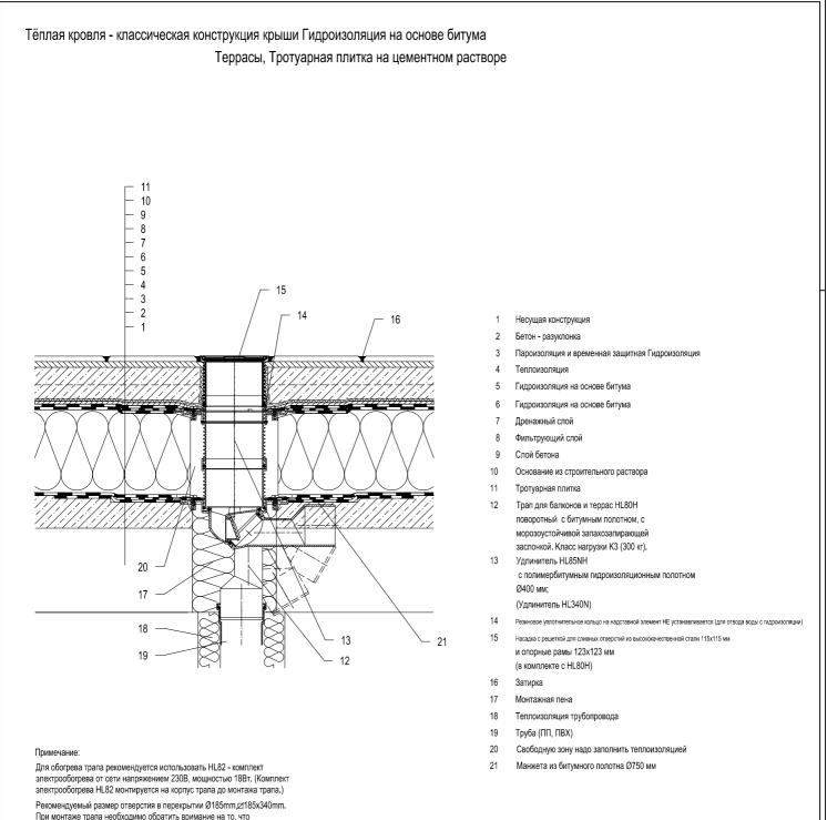
фланец корпуса трапа должен быть нижней точкой водосбора. Поэтому мы рекомендуем фланец корпуса трапа устанавливать на 10 мм ниже разуклонки.
